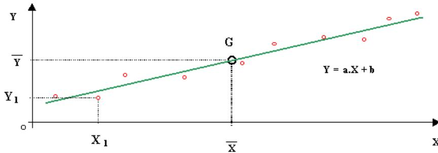
**Exemple :** On fait l'acquisition de la réponse linéaire d'un capteur quelconque et l'on obtient un nuage de points matérialisés en rouge sur la figure ci-dessus, on désire tracer la droite qui passe au mieux par ce nuage de points et connaître son équation qui est de la forme  $Y = Ax + b$ .
