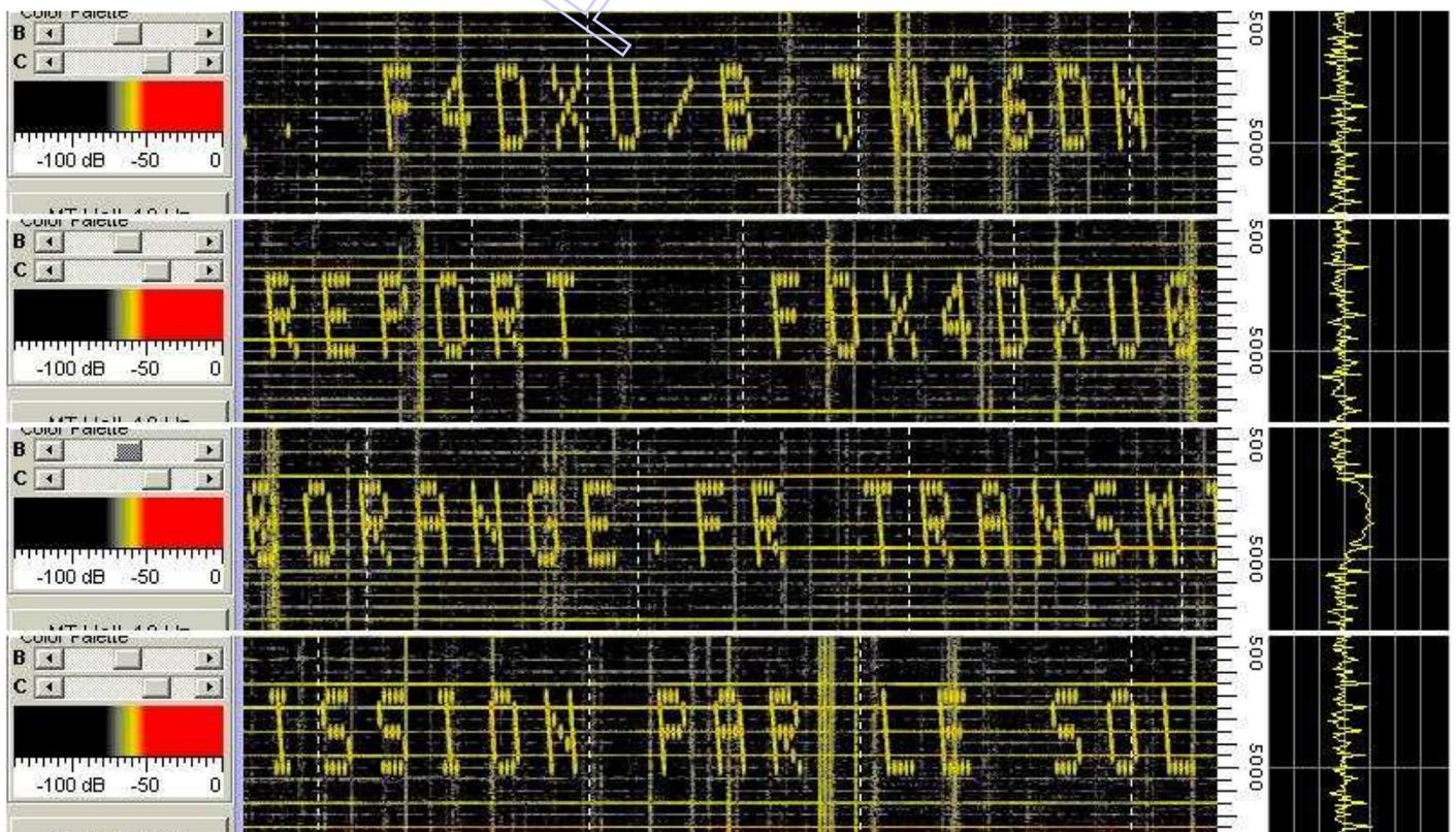
Le spectre vertical sur la droite de l'image (ci-dessus) à une échelle relative de -20 dB/carreau, on constate que le niveau maximum du signal est de 20 dB supérieur au niveau moyen du plancher de bruit ce qui laisse encore de la marge. Le texte est parfaitement lisible malgré le QRN.
