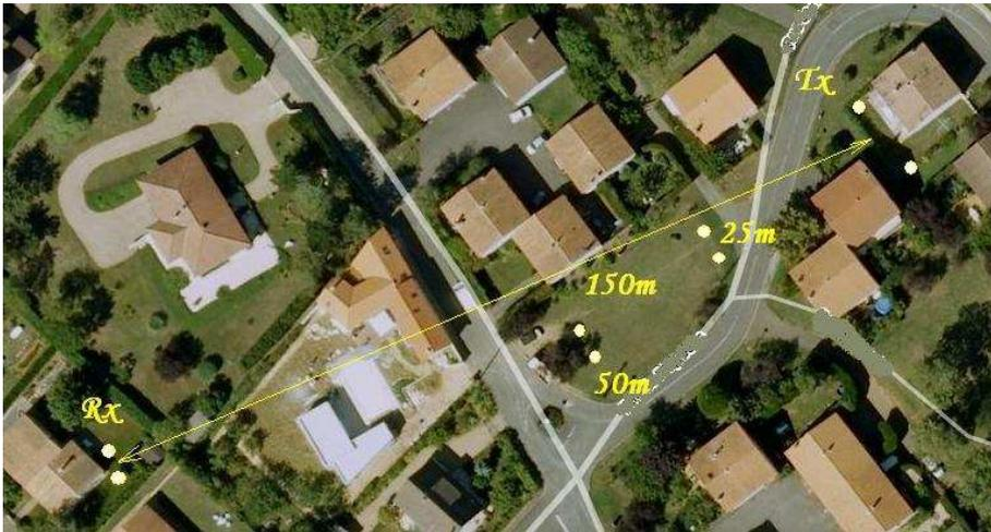
Les antennes Rx et Tx sont quasiment parallèles et distantes de 150m. Un essai de positionnement des antennes en quadrature a montré un affaiblissement d'environ 20dB. Aussi, plus les piquets de mesure de l'antenne Rx sont espacés
